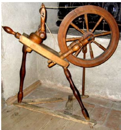
5. attēls. Vērpjamā ratiņa paminu kustīgs savienojums izmantojot nelielu ādas gabalu. Latvijas Brīvdabas muzejs.
